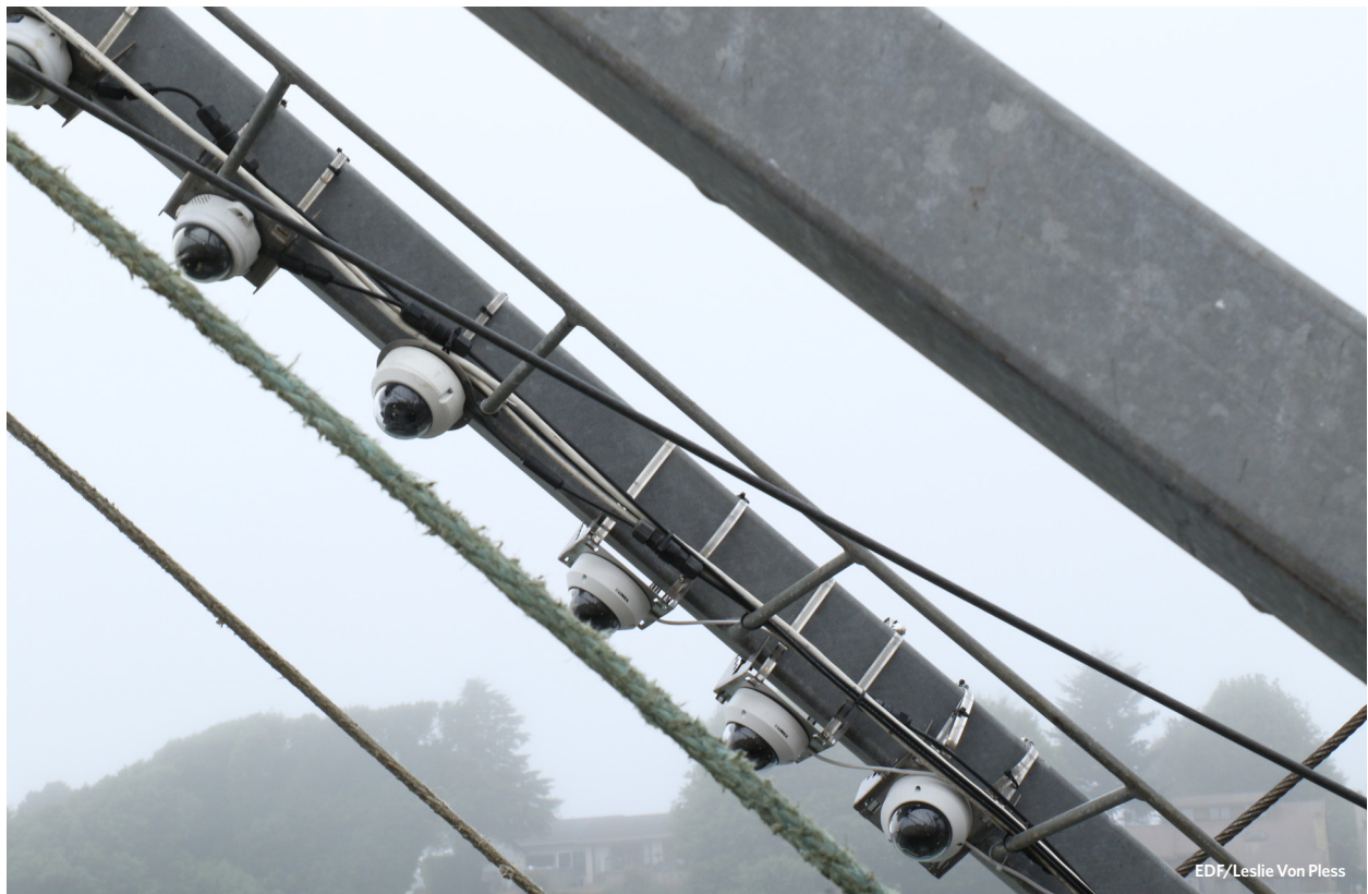
하단 트롤러의 전방 리깅에 고정 렌즈 카메라 부착.
